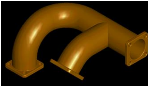
מודל מוצק (Solid) - הגוף מיוצג כמסה מרחבית בעלת משהל, נפח אינרצה, פני שטח וכדומה
