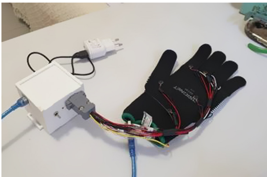
הכפפה מצוידת בחיישנים שמזהים מגע ובמנועי רטט והיא מיועדת בעיקר לילדים שסובלים מהיעדר תחושה
